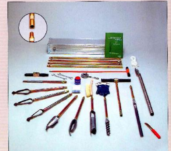
Grondboorset met ronische schroefdraadverbinding
