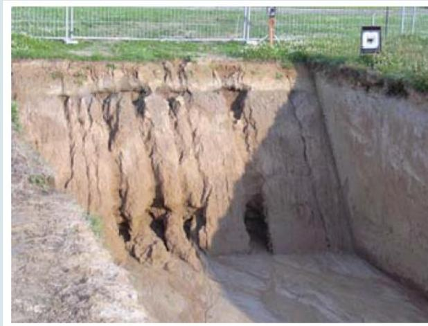
*Rupture progressive par fluage d'un sol argileux (CSTC)*
