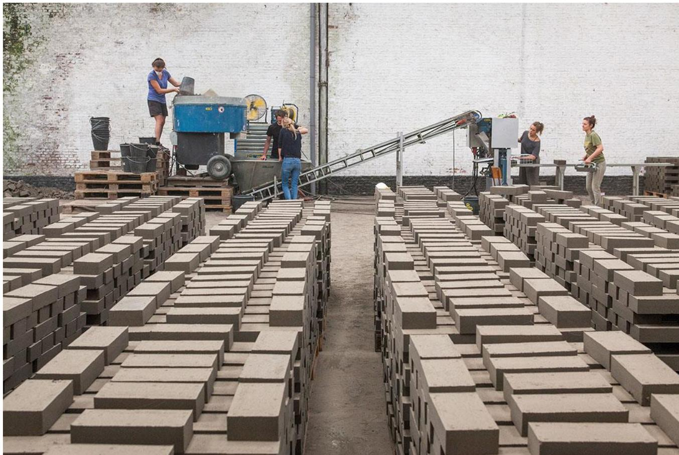
Production de briques, pisé et enduits à partir de terres excavées
